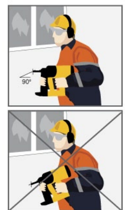
Rys. 2. Prawidłowe ustawienie osadzaka w stosunku do podłoża
